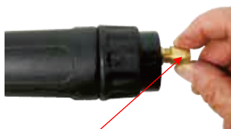
(6) Asenna lankaputken pidätinmutteri ja ruuvaa vain 1/2 kierrosta.
