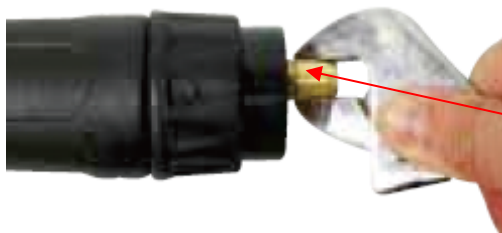
(9) Ruuvaa lankaputken pidätinmutteri kiinni ja purista se tiukkaan.
