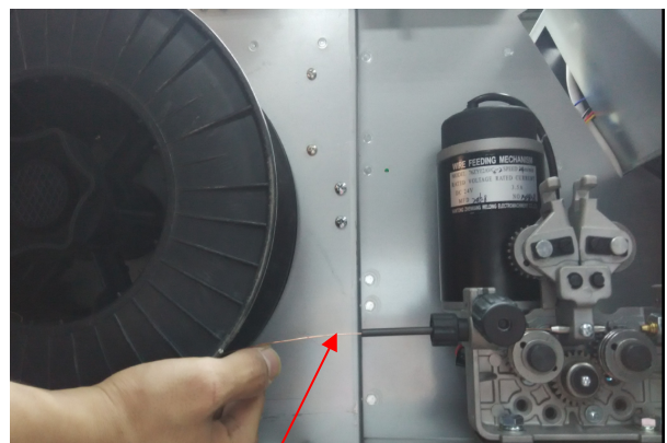
(4) Leikkaa lankaa huolellisesti ja pidä langasta kiinni, jota se ei purkaudu kelalta. Syötä lankaa varovasti langansyöttölaitteen sisääntulon ohjausputkeen.
